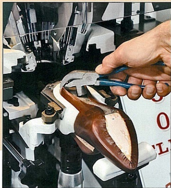
Fase uscita piantone con scarpa bloccata Phase of last post outwards movement with blocked shoe Fase de salida soporte con calzado bloqueado 钉跟座向上后移回位
